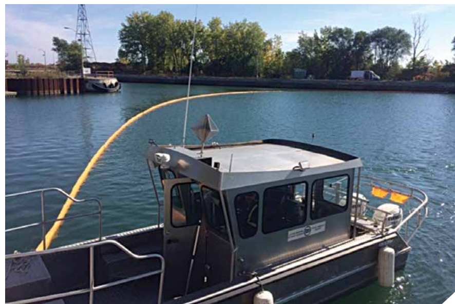
Déploiement d'un barrage flottant aux écluses de Beauharnois pendant une simulation de déversement de pétrole, en 2014.
