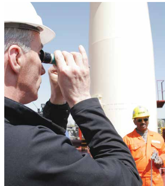
L'inspecteur de la Voie maritime Robert Elliott vérifie la salinité d'un échantillon d'eau de ballast.
