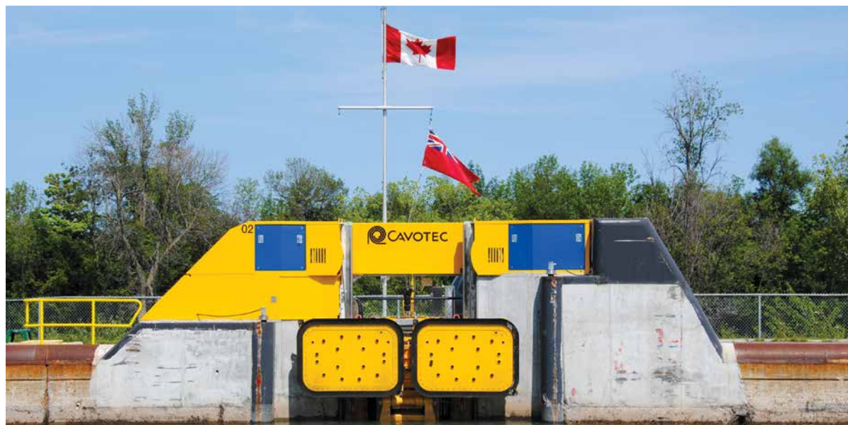
Gros plan d'une unité AML avec ses doubles ventouses
